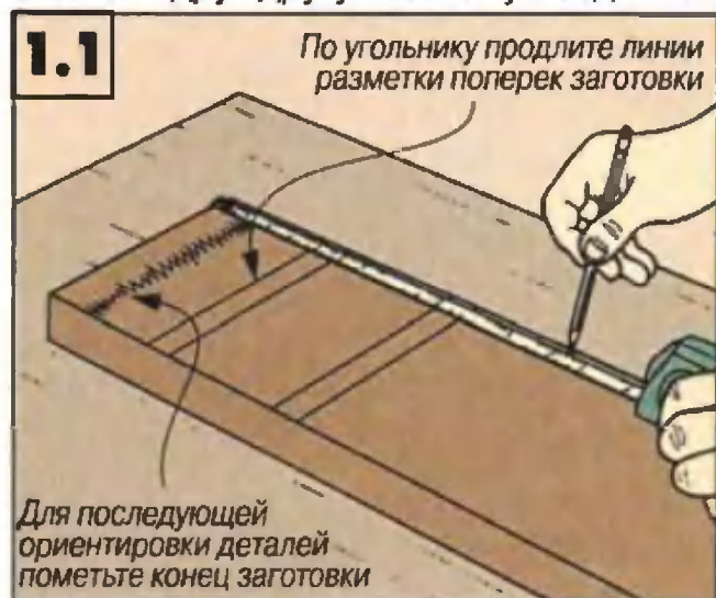
Начните с ориентации заготовки. Позже она будет распилена на отдельные рабочие детали (см. рис. 6). Затем одновременно разметьте все пазы.
