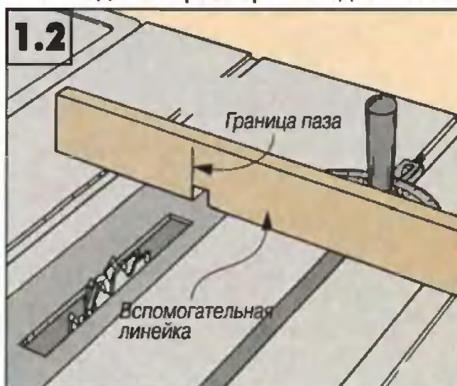
Установите диск для пазов и прикрепите вспомогательную линейку-шаблон. Совместите паз на линейке с диском, линия границы паза, должна быть видна.
