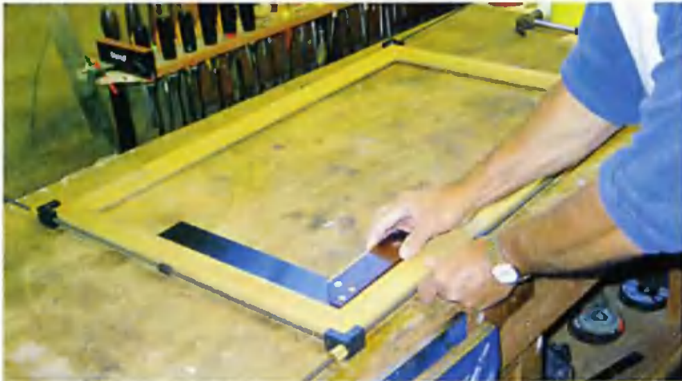
9 Рама собрана с помощью простого приспособления.
