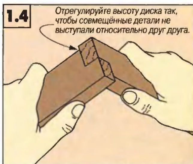
Сделав такой же запил на другой пробной детали, проверьте их подгонку. Если необходимо, отрегулируйте высоту диска.
