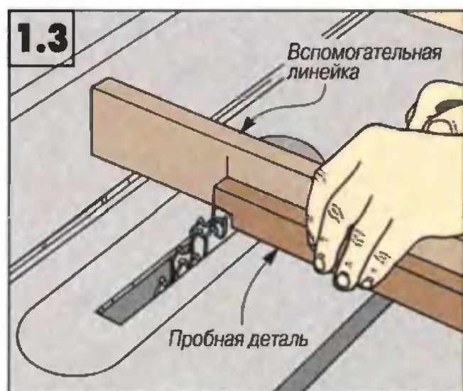
Вылет диска для пазов должен быть равен половине толщины заготовки. Сделайте пробную выборку паза.
