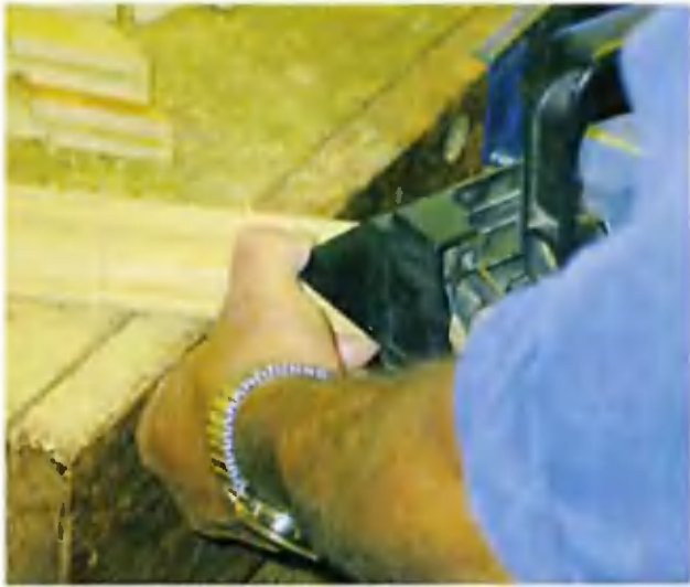
6 Для каждого стыка выбрал пазы под «бисквиты».
