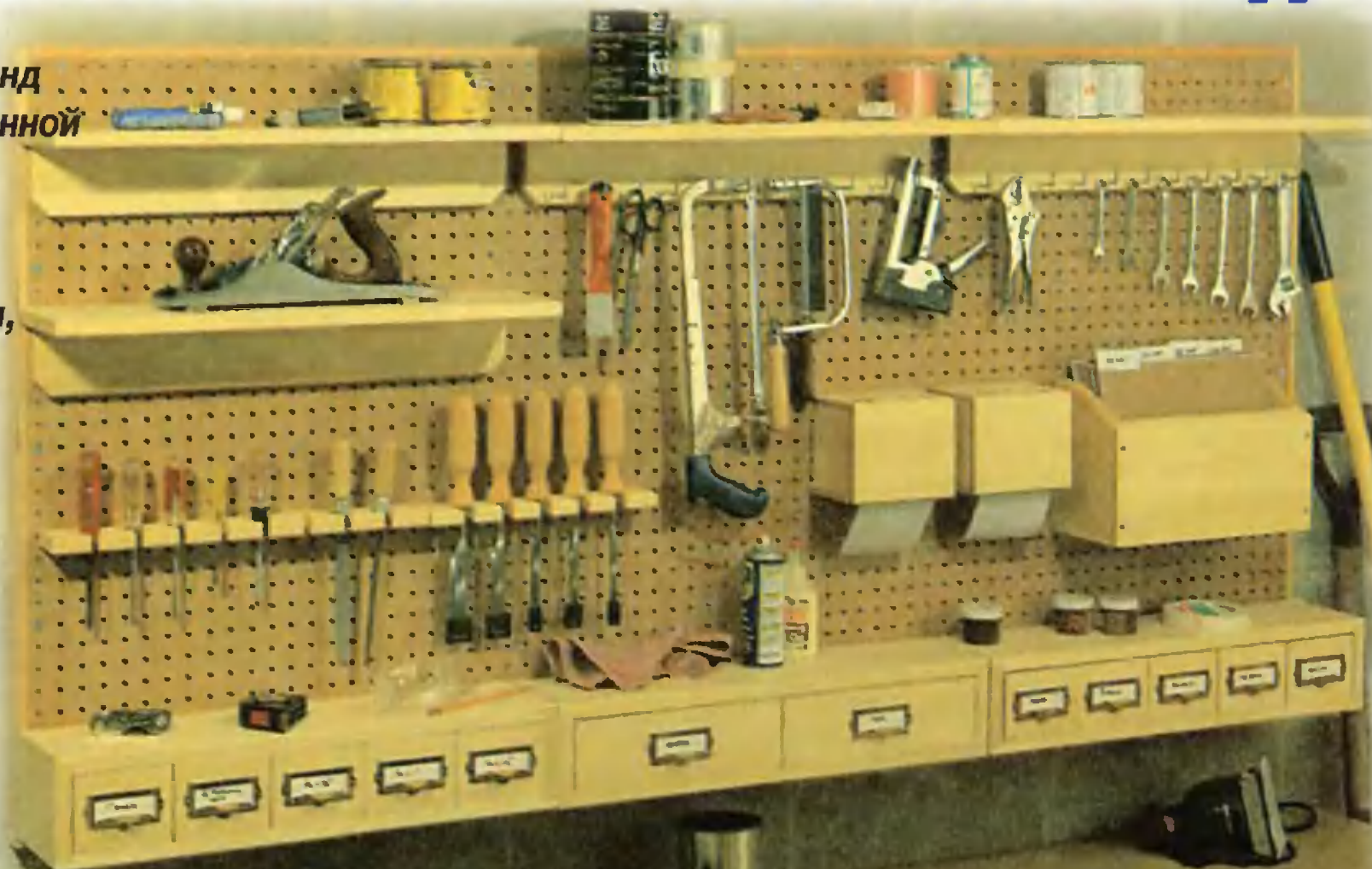
Универсальный стенд для инструментов на основе перфорированной панели полезен в любой мастерской. Полки и выдвижные ящички расширяют ассортимент хранимых предметов.
