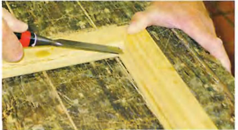
10 После высыхания клея подрезал выступающие концы «бисквитов».
