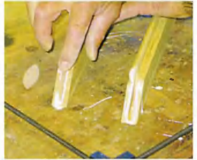
8 Шпонки вклеиваем в пазы.
